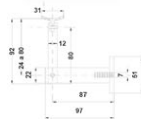
BRK 3041-2 Conector base redonda de muro a pasamanos plano.
