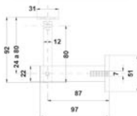
BRK 3041-1 Conector base redonda de muro a pasamanos redondo.
