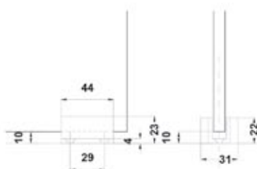
BRK 3850-1G. Tope con instalación a barra cuadrada.
