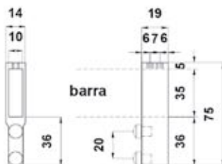
BRK 3850-1J. Carretilla sencilla con sujeción a cristal para barra cuadrada de sistemas de puertas corredizas 8-12 mm. Peso máx 100 kg.
