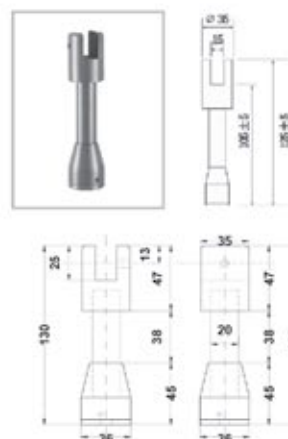
■ BRK 3801 Soporte redondo para panel de cristal con sujeción a piso 8-12mm.
