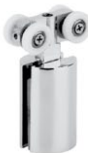
BRK 3930B-20. Carretilla sencilla con sujeción a cristal para barra cuadrada de sistemas de puertas correderas 8-12 mm. peso máx 100 kg
